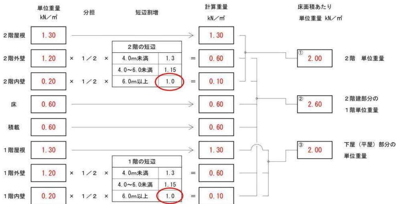
外壁、内壁重量は階の中央で上階、下階に分けるため1/2を乗じます。
